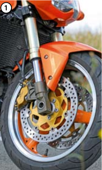
1 Fourche inversée, certes, mais le mordant du freinage est un poil léger. 2 Le tableau de bord est identique à celui de la ZX-6 R de l'époque. La fonction chrono en moins. 3 MAGNIFIQUES ! Mais les flûtes d'échappement font perdre presque 10 ch à la Z. Et s'avèrent assez lourdes.
