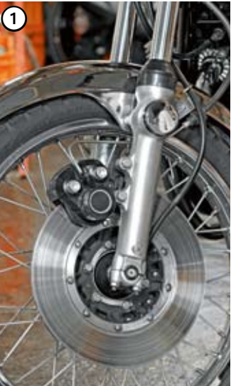
1 Après 1975, la 900 bénéficiera de deux disques à l'avant. C'est mieux. 2 Difficile de faire plus simple et plus lisible. De plus, la finition est plutôt soignée. 3 Les doubles sorties d'échappement, marque de fabrique des grosses Z. Toutes générations confondues.
