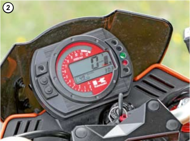
1 Fourche inversée, certes, mais le mordant du freinage est un poil léger. 2 Le tableau de bord est identique à celui de la ZX-6 R de l'époque. La fonction chrono en moins. 3 MAGNIFIQUES ! Mais les flûtes d'échappement font perdre presque 10 ch à la Z. Et s'avèrent assez lourdes.
