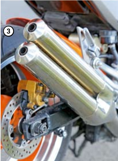
1 Fourche inversée, certes, mais le mordant du freinage est un poil léger. 2 Le tableau de bord est identique à celui de la ZX-6 R de l'époque. La fonction chrono en moins. 3 MAGNIFIQUES ! Mais les flûtes d'échappement font perdre presque 10 ch à la Z. Et s'avèrent assez lourdes.
