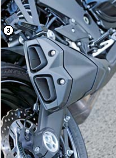
1 Etriers à fixation radiale, disques pétales, ABS... Le top du top, fils. 2 L'inclinaison du tableau de bord se règle. Quant à son look, il est ultra-futuriste. De là à dire qu'il vieillira vite... 3 L'échappement 4-en-2-en-2 se termine par des silencieux massifs. On est moins fan.
